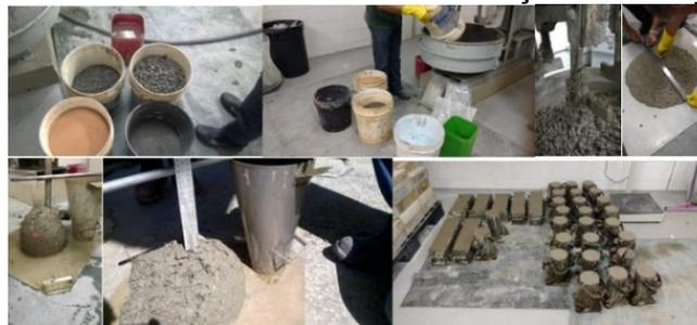
Figura 8: Verificação dos traços em laboratório
